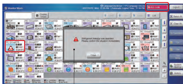
Wyskakujące okienko z informacją o wycieku
